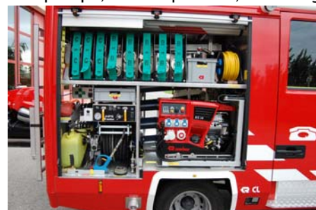
Raum 2: Höchstdrucklöschanlage, Stromerzeuger 14 kVA
