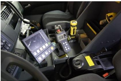
Automatisiertes Schaltgetriebe / Bedienelemente für Pumpe, Verkehrsleiteneinrichtung, Beleuchtung und Seilwinde
