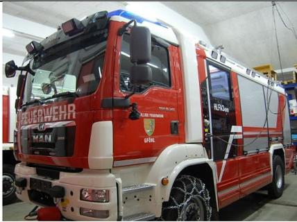
Ansicht vorne mit 8-Tonnen-Seilwinde
