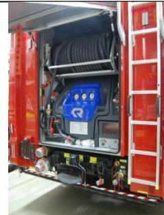
Hoch- und Normaldruckpumpe, Hochdruckhaspel, Bedienteile für Pumpe, Beleuchtung, Verkehrsleiteneinrichtung, Einbaugenerator, Digimatic
