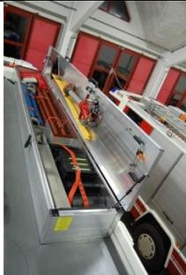
Am Dach: Box mit Saugschläuchen, Bausteinern und Schlauchbrücken, sowie Schiebleiter und Wasserwerfer
