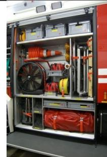
Elektrischer Druckbelüfter, Rettungsplattform, faltbarer Wassertank für 5000 l (z.B. für Fremdspeisung durch Güllefässer), Nass- und Trockensauger
